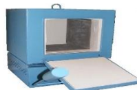
Figura 5. Mufla utilizada para la incineración de ceniza a 800°C
