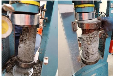
Figura 20. Fotografía de la falla evidenciada luego de la aplicación de cargas
