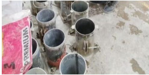
Figura 10. Fotografía de los moldes cilíndricos de medidas de alto 20 cm por diámetro de 10 cm Fuente: Elaboración propia
